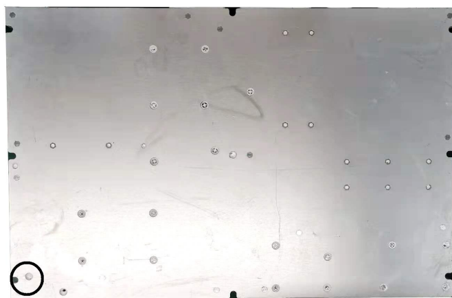
绝缘测试时, 拆除此处螺丝
